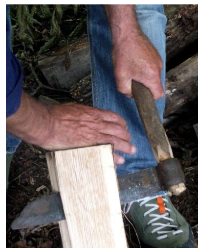
Ил. 7. Работа с цепило, детайл. Архив Сдружение „Мещра“, 2018
