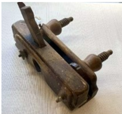
Ил. 10. Платовник – ренде за профили, използвано при изработката на таблени врати. Фонд МАИР „Боженци“, сн. П. Груева, 2024 г.
