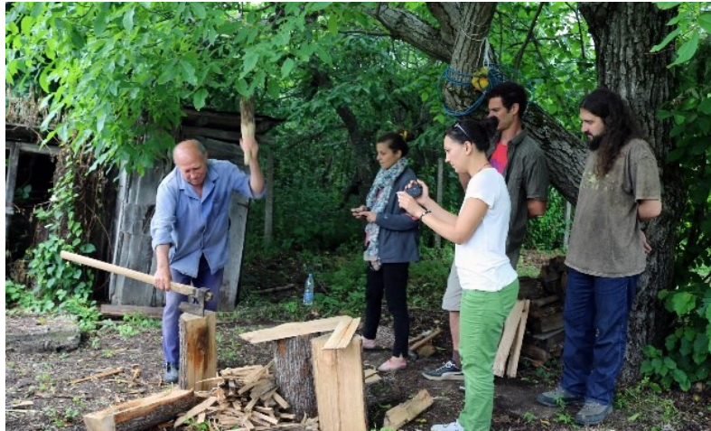
Ил. 3. Разцепване на цепеница с брадва и дървен чук (демонстрационна работилница, на снимката: майстор Йовно Йовнев). Архив Сдружение „Мещра“, 2017 г.
