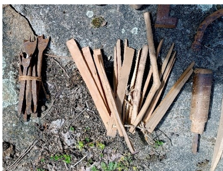
Ил. 13. Дървени клинове, използвани за напасване (прибиране) при сдвояване на дървени детайли. Фонд МАИР „Боженци“, сн. П. Груева 2024 г.
