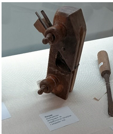
Ил. 11. Колцар – ренде за дървена дограма. Фонд МАИР „Боженци“, сн. И. Аргирова, 2024 г.
