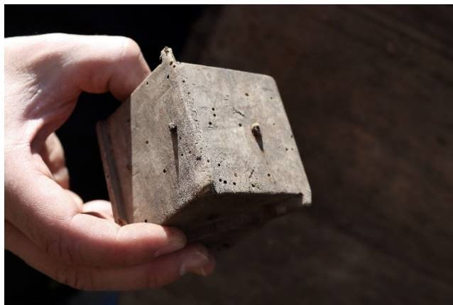
Ил. 12. Чап (чертилка) – инструмент за изчертаване на успоредни линии чрез надраскване. Фонд МАИР „Боженци“, сн. И. Аргирова, 2024 г.
